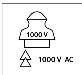
Isolierte Werkzeuge und isolierende Hilfsmittel zum Arbeiten an unter Spannung stehenden Teilen sind geeignet, wenn sie mit dem Symbol des Isolators oder mit einem Doppeldreieck und der zugeordneten Spannungs- oder Spannungsbereichsangabe oder der Klasse gekennzeichnet sind.
